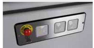
Удобная и функциональная панель управления, оборудована ключом доступа.
